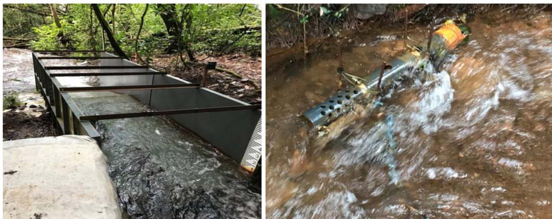
Figure 14 : Canal à SW-09 (Zougoué) enregistrant le niveau d'eau. Figure 15 : Capteur de turbidité installé à SW-08 (Zié).
